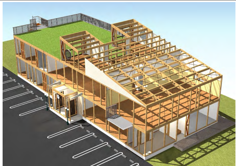
屋根構面 勾配用オメガメタルブレース 取り付け図
