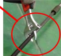
ジョイントボルトが回らないようボルト軸部にプレス加工を設けています。
