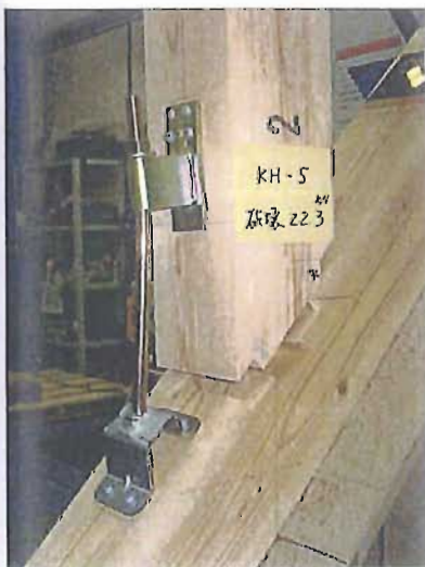
写真-5 破壊状況 番号：5 最大荷重：22.3kN ほぞの割れを伴うほぞの外れ後、M座金ボルト孔の切れ
