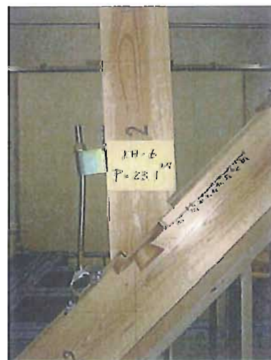
写真-5 破壊状況 番号：5 最大荷重：22.3kN ほぞの割れを伴うほぞの外れ後、M座金ボルト孔の切れ
