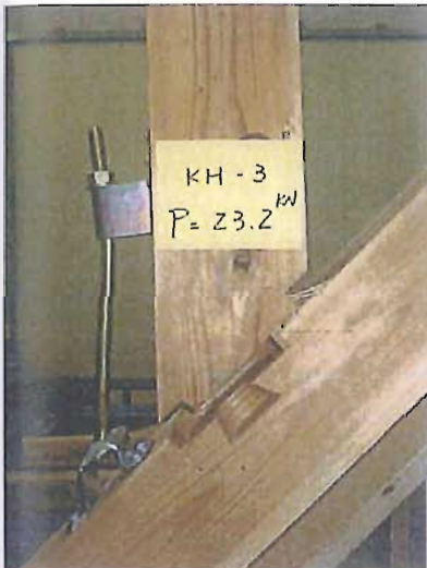
写真-3 破壊状況 番号：3 最高載荷荷重：23.2kN 支持梁の割れ及びほぞの外れ後、金物及びM座金の変形進展
