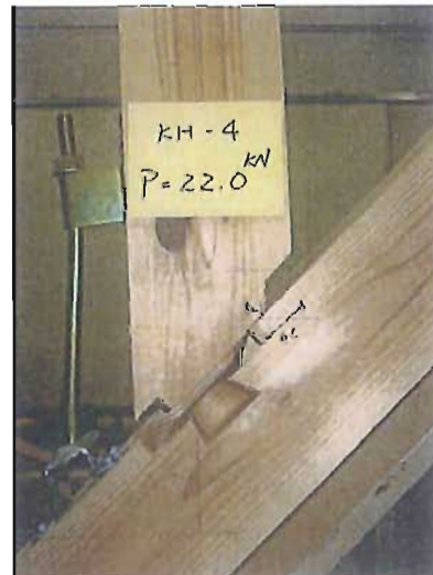
写真-3 破壊状況 番号：3 最高載荷荷重：23.2kN 支持梁の割れ及びほぞの外れ後、金物及びM座金の変形進展
