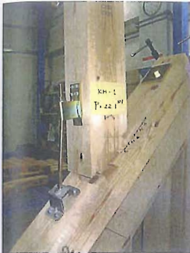
写真-1 破壊状況 番号：1 最高載荷荷重：22.1kN 支持梁の割れ及びほぞの外れ後、金物及びM座金の変形進展
