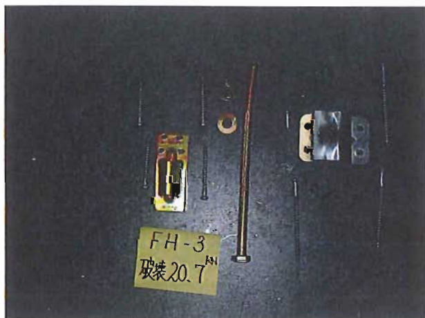
写真-3 破壊状況 番号：3 P_{max}=19.9\text{kN}
