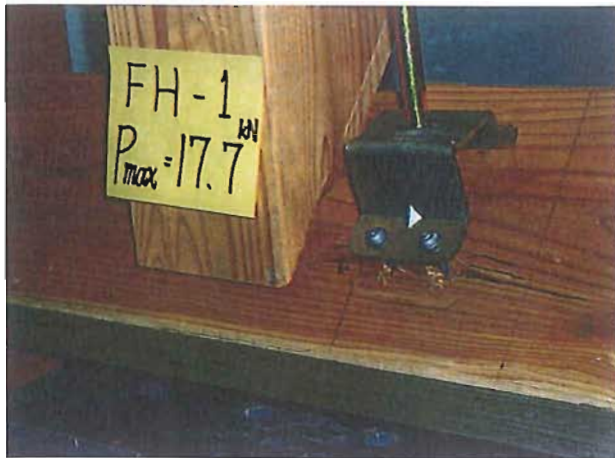
写真-1 破壊状況 番号：1 P_{max}=17.7\text{kN}
