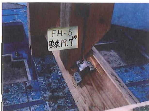
写真-5 破壊状況 番号：5 P_{max}=18.4\text{kN}
