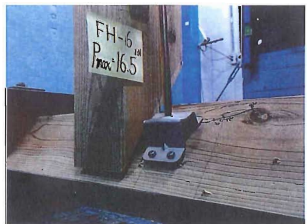
写真-6 破壊状況 番号：6 P_{max}=16.5\text{kN}
