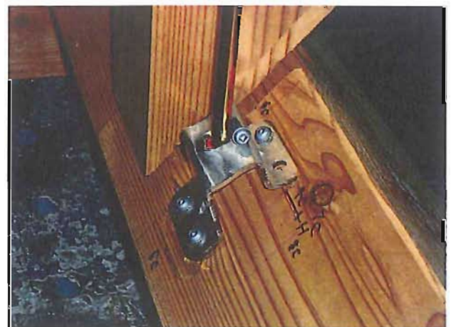
写真-4 破壊状況 番号：4 P_{max}=19.0\text{kN}
