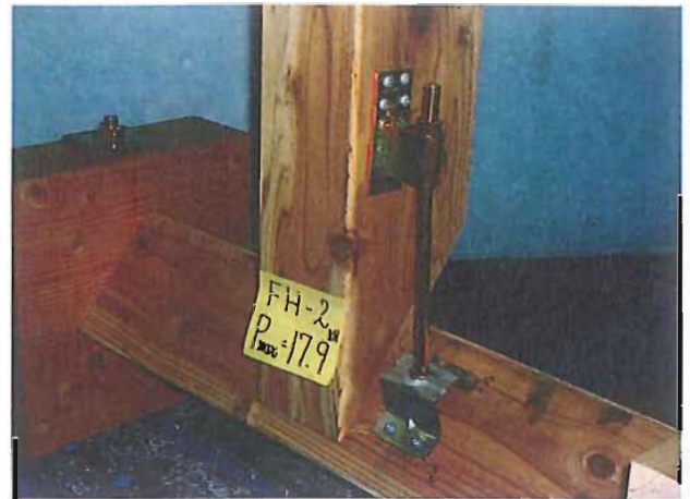
写真-2 破壊状況 番号：2 P_{max}=17.9\text{kN}
