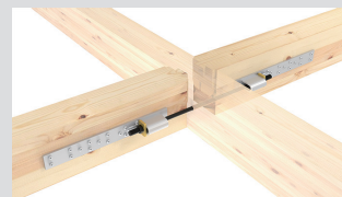
〈両引きセット〉 短期基準接合耐力 35.8kN
